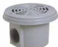
Orifice latéral 50 à coller Orifice de fond taraudé 1"1/2 avec opercule défonçable
